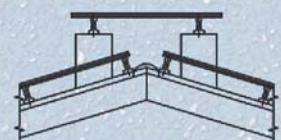
PORTIQUE AVEC BERCEAU D'AÉRATION
